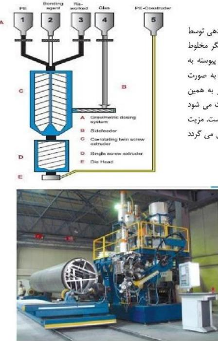
شکل ۱. فناوری تولید لوله های پلی اتیلن تقویت شده با الیاف شیشه
