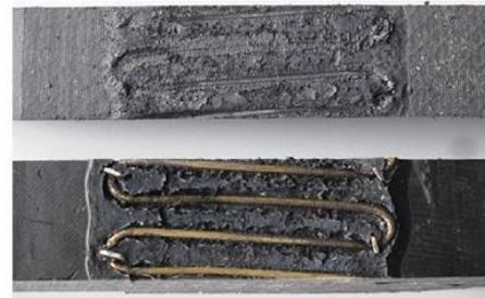
شکل ۵. نتایج جدایش اتصال الکتروفویوزن
